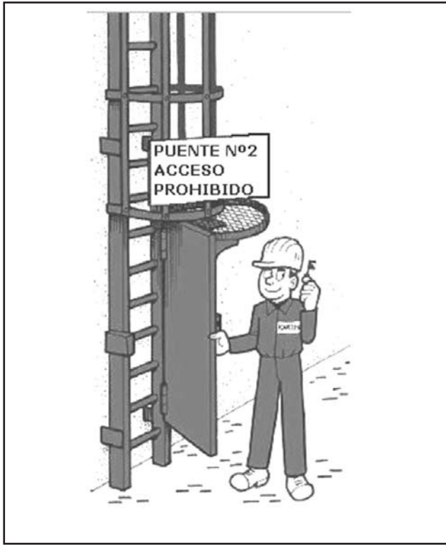
Figura 19. Ejemplo de restricción de acceso a una zona peligrosa de un equipo de trabajo
