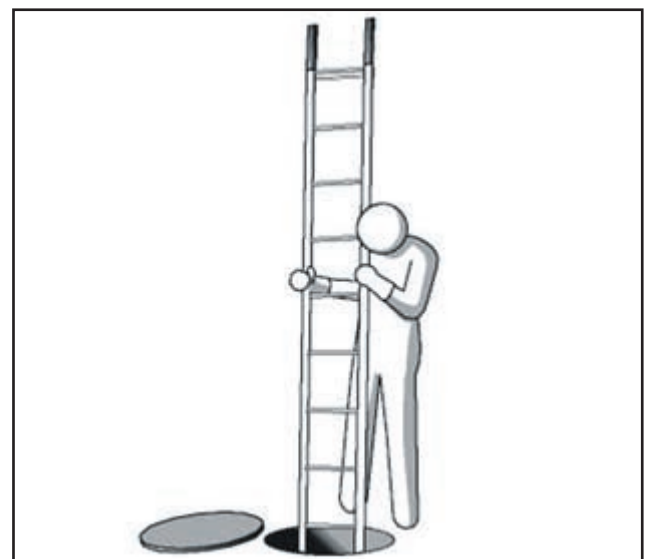
Figura 33. Ejemplo de utilización de escalera de mano en un espacio reducido
