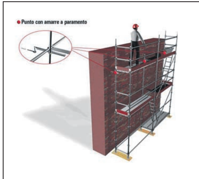
Figura 58. Detalle de anclaje a parámetro de hormigón, de un andamio de fachada de componentes prefabricados
