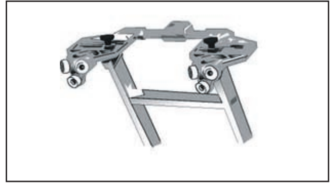
Figura 36. jemplo de dispositivo para el apoyo de una escalera simple sobre ambos largueros
