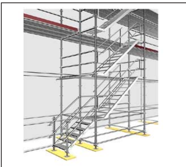
c) escalera de servicio adosada a un andamio
