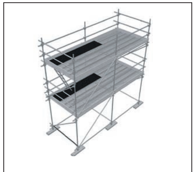
Figura 53. Ejemplo de andamio metálico tubular no modular
