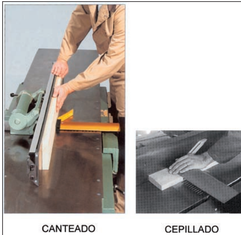
Figura J7a. Resguardo de cierre automático en una cepilladora
